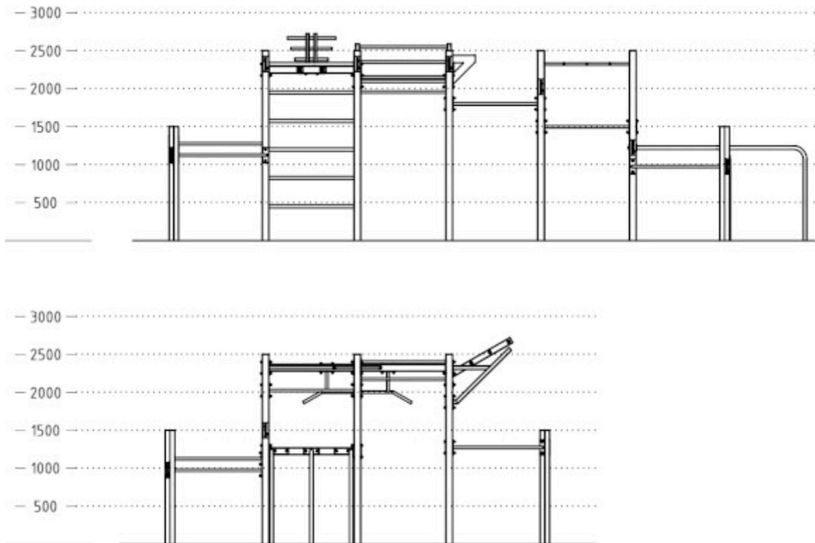
Die maximale Fallhöhe eines Outdoor Fitnessgerätes ist maßgebend für den benötigten Untergrund. Bei diesem Gerät wird folgender Untergrund benötigt:
